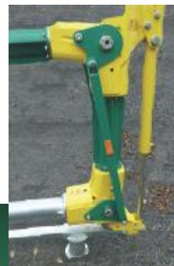
Doppelgelenk mit patentierter Synchronsteuerung
