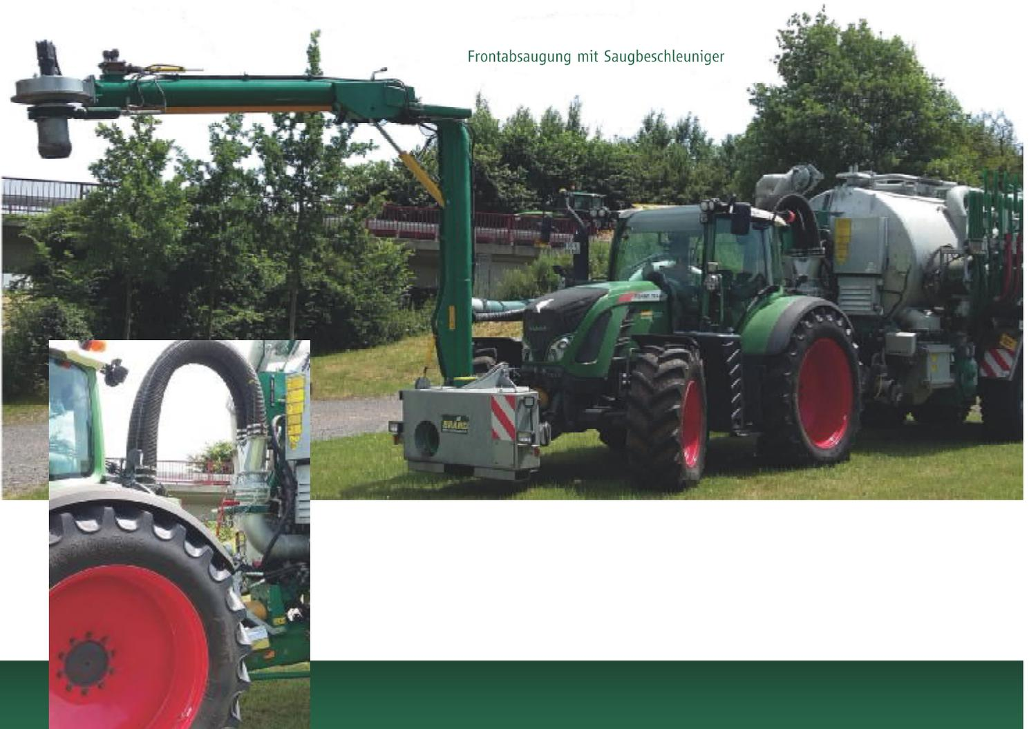
Verbindung vom Fass zum Schlepper
