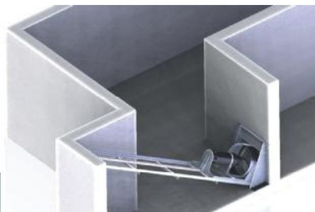
Variante A: mit Rührwerkskorb 700x700mm oder 625x625mm
