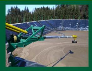
B02 mit 2 Hydraulikzylindern zum Absenken in die Lagune
