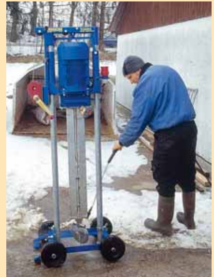
Das Reckgerät unterscheidet sich durch den Rührflügel und den Geräteaufbau.
