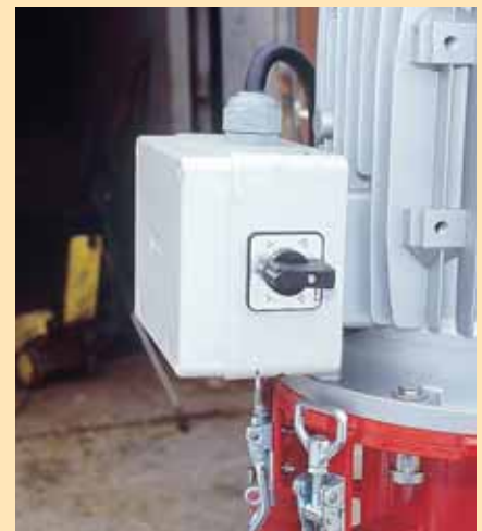
Einschalten und Wahl der Drehrichtung erfolgt mit dem Stern-Dreieckschalter.
