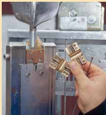
Das Fußlager aus einer besonderen Legierung ist zur einfachen Montage geteilt.
