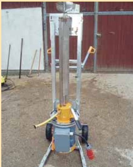
Der Mini-Mix in Transportstellung. Vorteil: niedriger Schwerpunkt.
