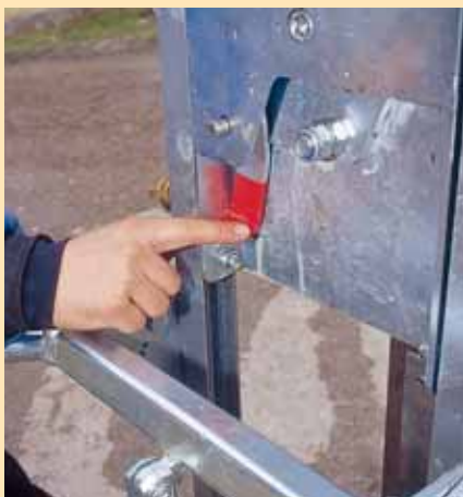
Dieser Hebel bestimmt Transportstellung, Schwenken oder festen Schwenkwinkel.
