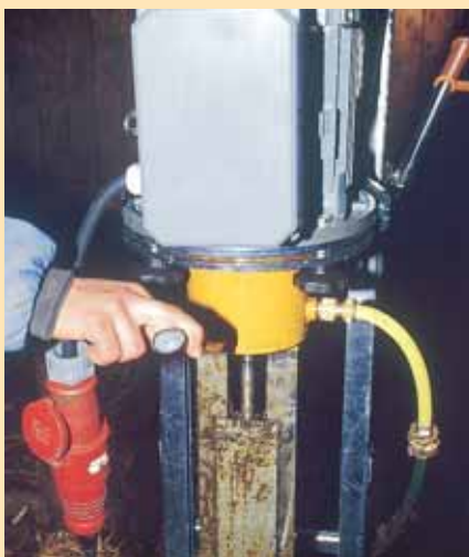
Zum Ausheben den Hebel ziehen und der Rührflügel passt durch die Spalten.
