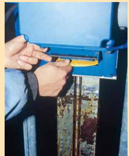
Das Ausrichten des Rührflügel zum Herausheben erfolgt mit der gelben Scheibe.
