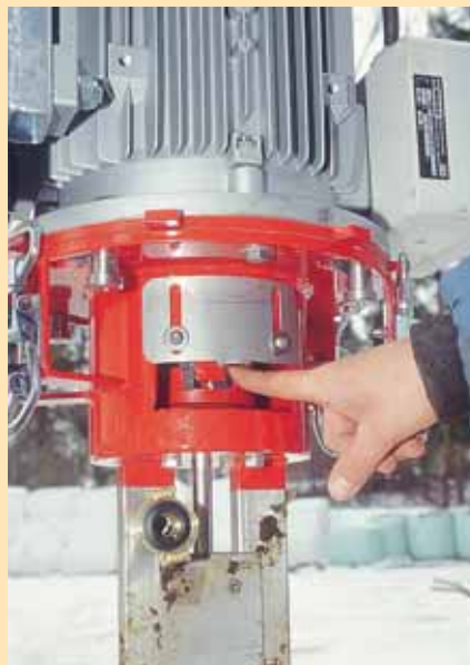
Etwas umständlich: Drehen der Klauenkupplung richtet den Rührflügel aus.
