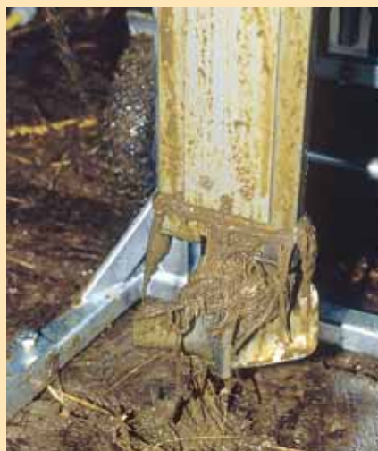
Stroh und Bänder können sich wickeln, gut ist die mitgelieferte Spritze zum Reinigen.
